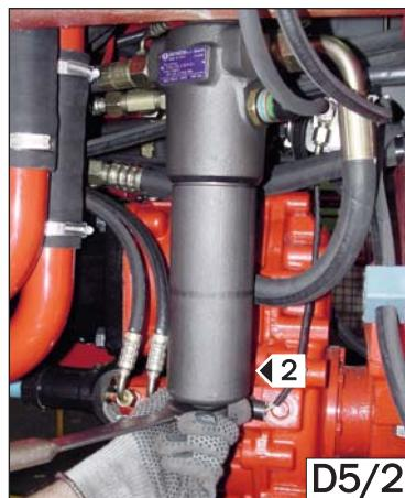
**D5 - Filter in Druckleitung des Hauptkreislaufs ersetzen**
