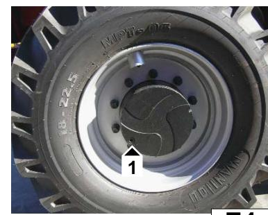
**E5 ▶ Sostituire olio riduttore 2 velocità sul ponte anteriore**
